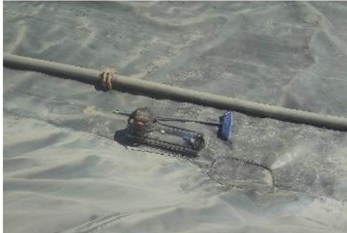
Recursos para prueba campana de vacío, agua, detergente y escobillón
