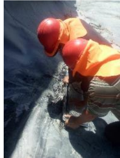
Aplicación de solución jabonosa sobre parche y prueba con campana de vacío
