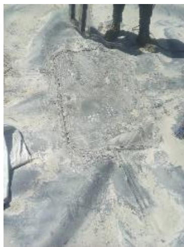
Prueba campana de vacío sobre perímetro de parche
