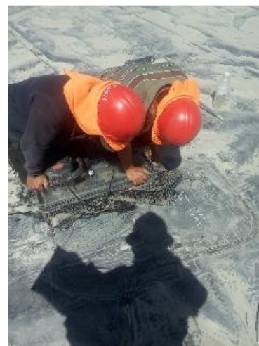
Prueba campana de vacío sobre perímetro de parche
